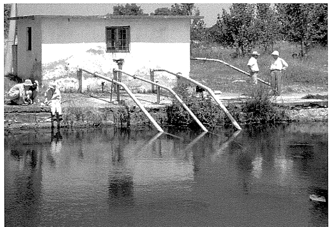
Abb. 10 Düden-Quelltopf QCF auf dem Gelände der Farm Bozcaada Tarım İşletmesi mit Pumpstation für landwirtschaftlich genutztes Wasser und dem an einem Schwimmkörper befestigten Diver® Datenlogger im rechten unteren Bildteil.
